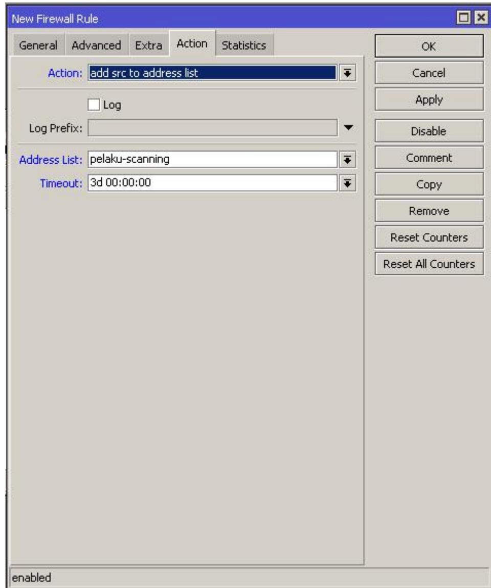
Sampai tahap ini saat dilakukan uji coba dengan melakukan scanning port maka IP Address host yang melakukan scanning akan masuk ke dalam address list dengan nama Pelaku Scanning seperti pada gambar berikut :
